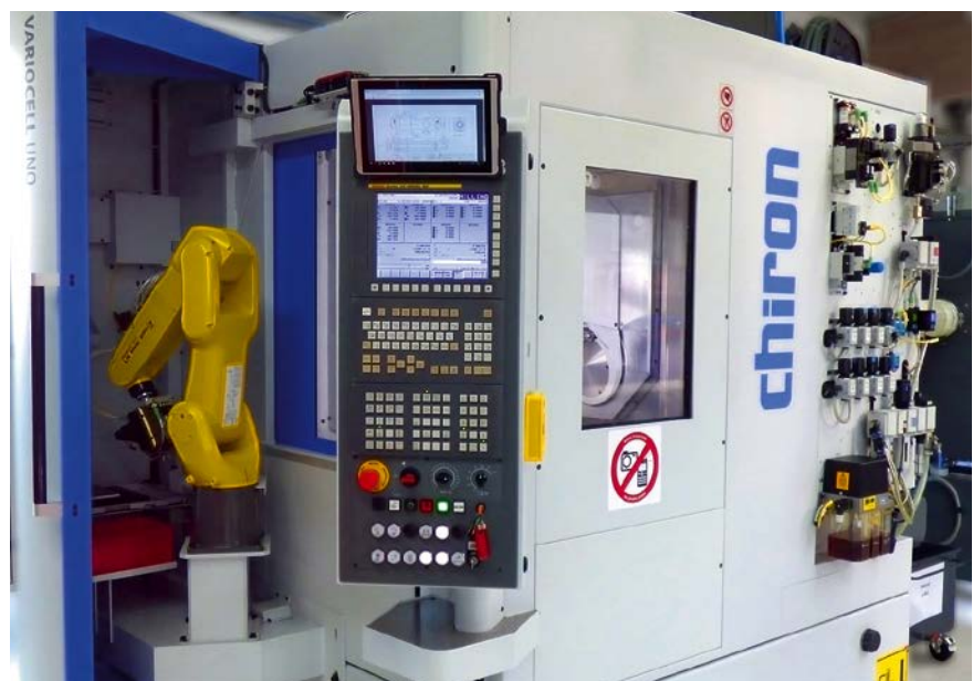
3 Kompakt und hochpräzise: Bearbeitungsgenauigkeiten im Mikrometerbereich ertüchtigen das Fräsdrehzentrum FZ08 MT Precision+ mit angedockter Roboterzelle Variocell Uno zur autarken Fertigung der Schaftkomponenten über einen Zeitraum von über zwei Tagen hinweg (© Hanser)
